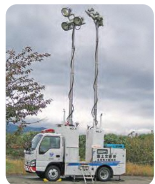
作業を照らす照明車
