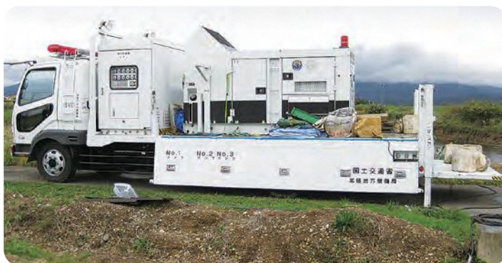
排水ポンプ車で水を排水する
