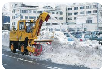
ロータリー除雪車による除雪
