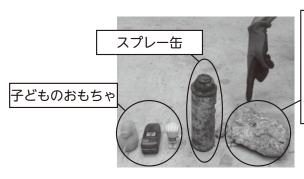
『オイルボール』 ※下水道管内で 油が固形化し た塊。写真は 処理場に流れ 着いたもの。
