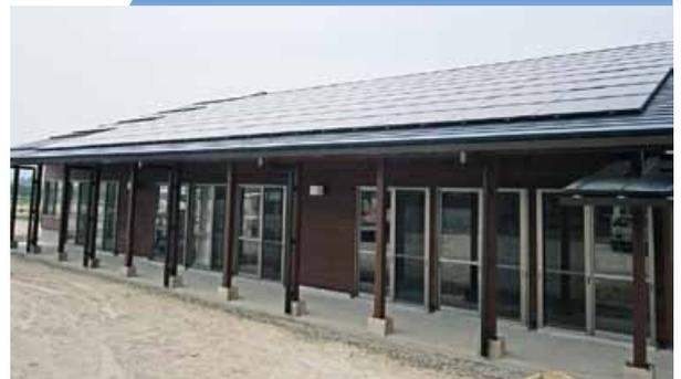
交流促進施設の屋根には太陽光発電パネルが設置され倉庫内にあるバッテリーに電気を蓄えます。停電時でも活動できるよう防災体制を整えました。
